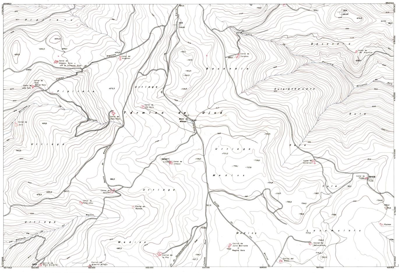
PLANO TOPOGRAFICO DE NAVARRA Trabajos geodésicos efectuados por el I.G.C. Fecha del vuelo ESCALA 1:5.000 EQUIDISTANCIA 5 M. PROYECCION U.T.M.
