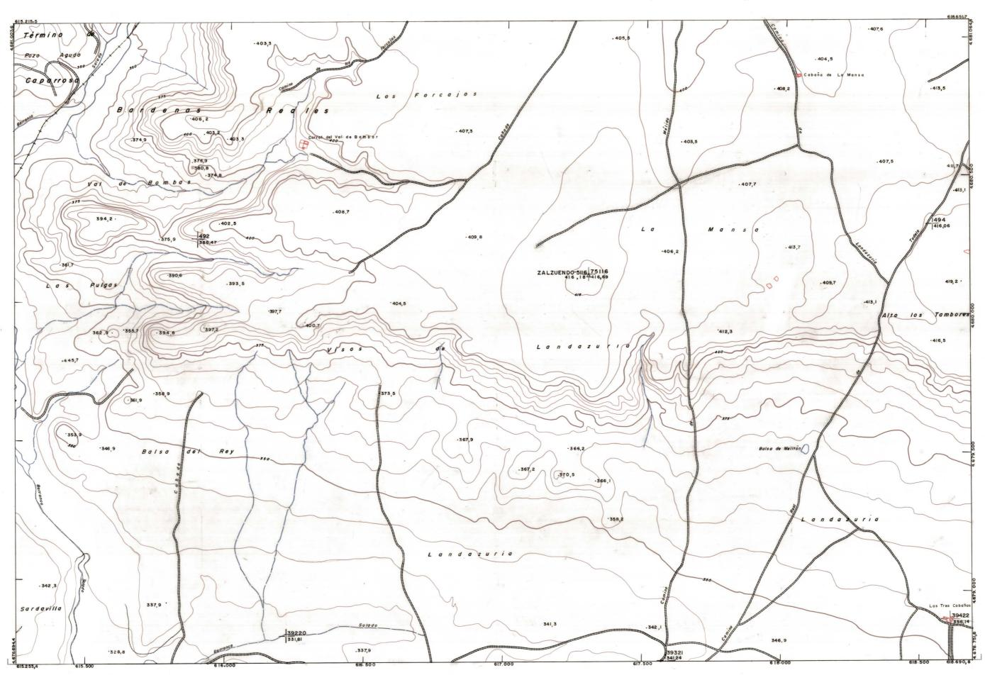
PLANO TOPOGRAFICO DE NAVARRA Trabajos geodésicos efectuados por el I.G.C. Fecha del vuelo ESCALA 1:5.000 EQUIDISTANCIA,5 M. PROYECCION U.T.M. Altitudes referidas al nivel medio del mar en Alicante
